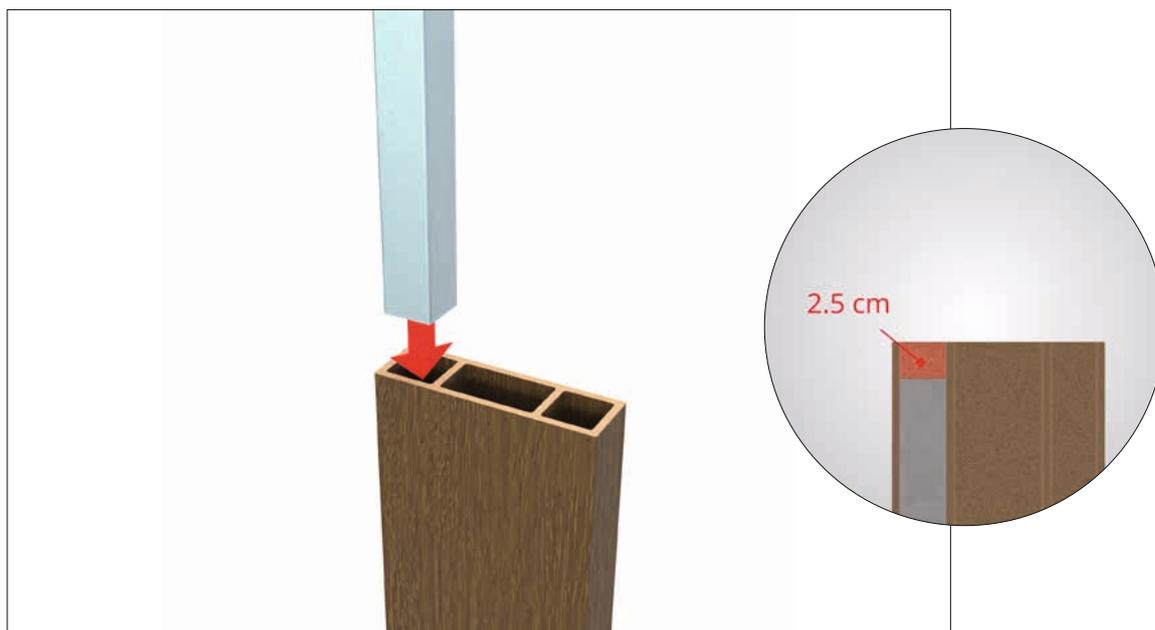
**SCHRITT 3** Schieben Sie die Stabilisierungsleiste in das Innere der WEO® Brise-Soleil und lassen Sie an den Enden 2,5 cm Spielraum.
