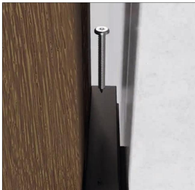
**SCHRITT 6** Montieren Sie den Clip oder die Profilschiene mit der selbstbohrenden Edelstahlschraube 5.5x50mm FC2933/ FD1223 (oder 5.5x32mm FC2626/FD1155) und einem verlängerten Bit auf der tragenden Profilschiene.
