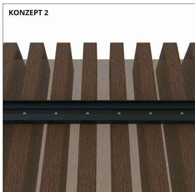
**SCHRITT 4B** Montage der Profile mit der Profilschiene FC2626 / FD1156, die zuvor auf die gewünschte Länge zugeschnitten wurde. Verwenden Sie die selbstbohrende Edelstahlschraube 5.5x32mm (FC2628/FD1155). Verschraubung in den Aluminiumkern.
