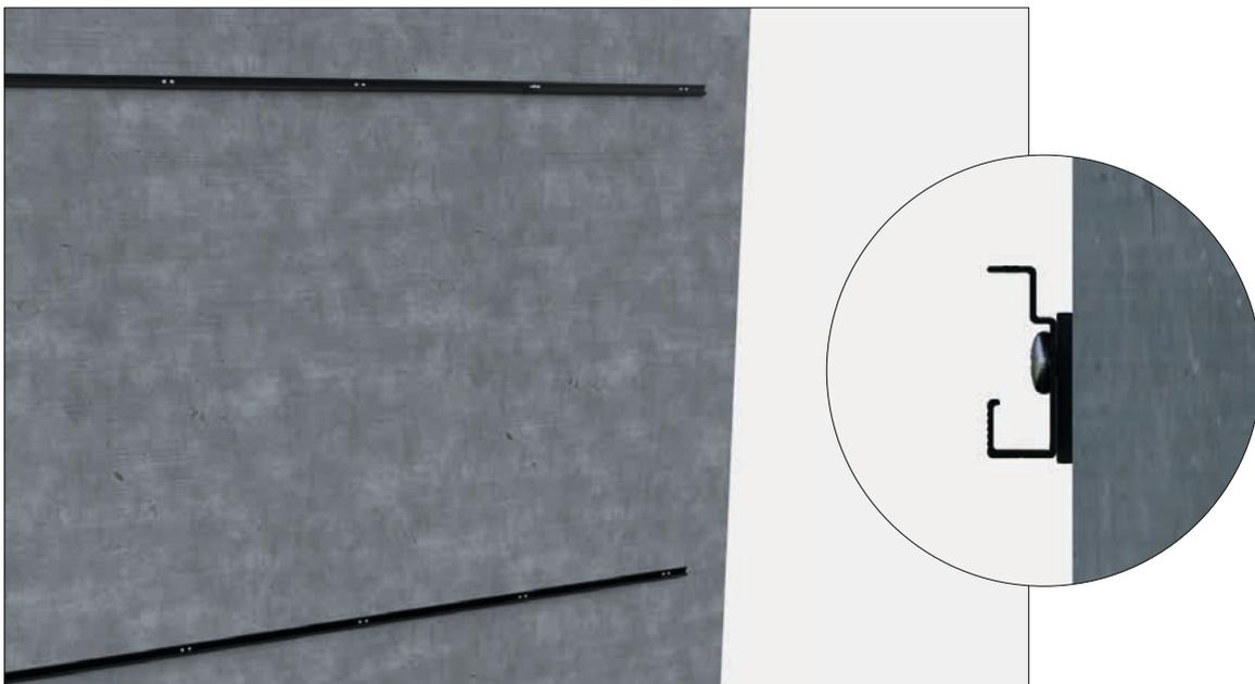
**SCHRITT 2** Befestige die Schiene (FC2625 / FD1156) mit für den Untergrund geeigneten Schrauben an der tragenden Wand.
