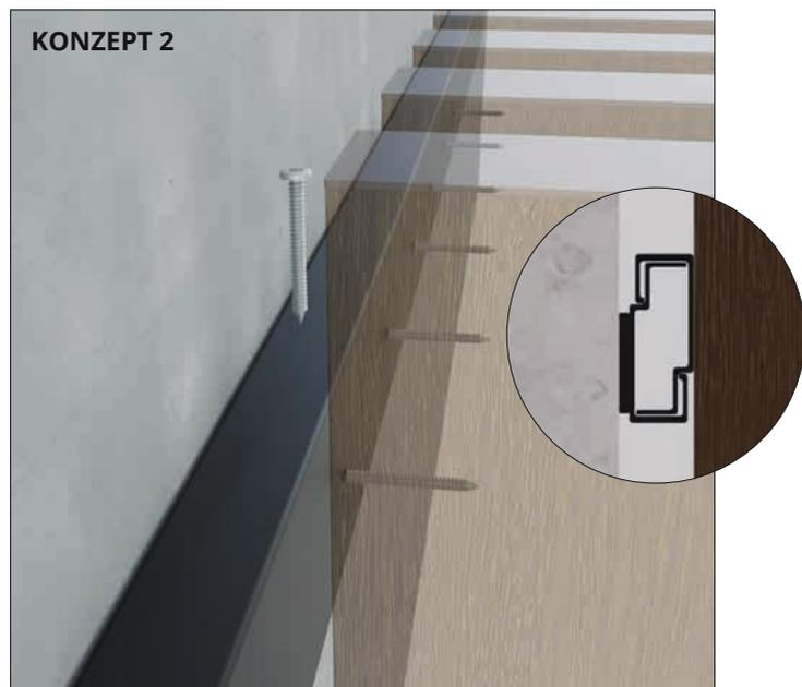
**SCHRITT 5A** Schieben Sie das Brise-Soleil auf die Profilschiene. Der Abstand zwischen den Profilen kann anschliessend mit der Stellschraube M6x20mm eingestellt und die Profile vertikal ausgerichtet werden.
