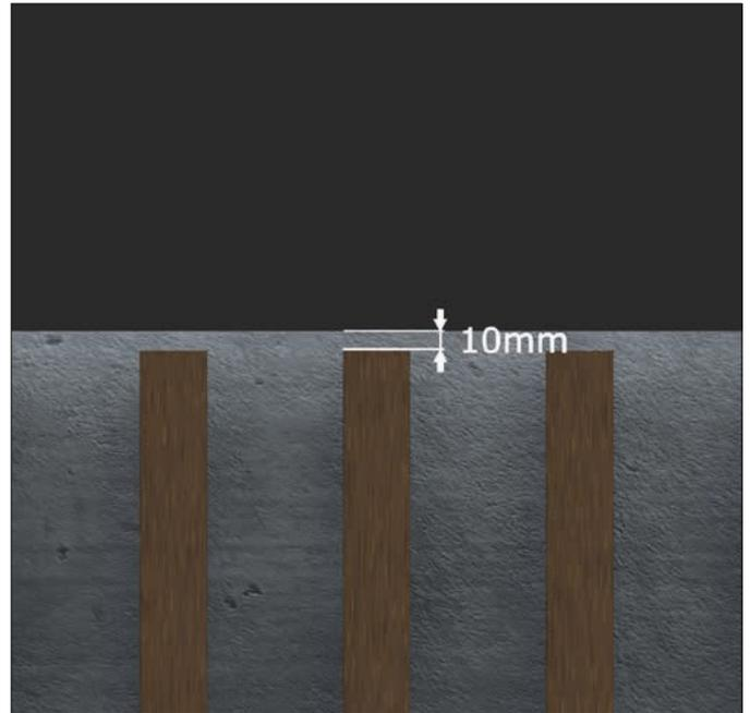
**DEHNUNGSFUGE** Halten Sie einen Abstand von 5 mm zwischen zwei Enden eines Brise Soleil und 10 mm zwischen einem Brise Soleil und einem anderen Brise Soleil oder allen Arten von Hindernissen (Tischlerei, Wand, Ecke, etc.) ein.
