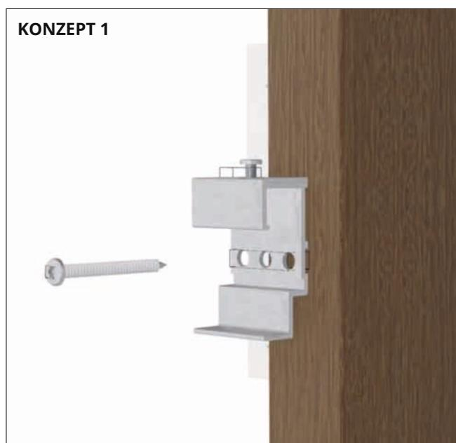
**SCHRITT 4A** Montage des Brise-Soleil mithilfe des Clips FC2625 / FD1154. Verwendung der selbstbohrenden Edelstahlschraube 5.5x32mm (FC2627 / FD1155). Verschraubung in den Aluminiumkern.
