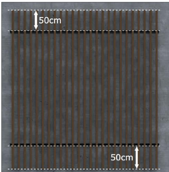
**ÜBERSTAND** Ein Überstand von 50 cm am Ende des Brise-Soleil ist zulässig. Die Stabilisierungsleiste muss über die gesamte Länge des Profils eingefügt werden.
