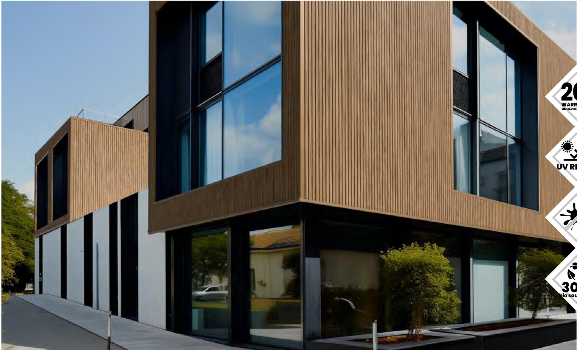
Le bardage WEO® 60 avec son profil à faux claire-voie permet de le poser rapidement à l'horizontal ou à la vertical. Les lamelles de 60mm de large sont régulièrement espacées d'un jour de 10mm. Les lames sont légères et faciles à installer, mais aussi très stables avec notre système de fixation. Il est possible de mixer les profils WEO® 35 et WEO® 60 pour donner du rythme à la façade, comme également l'associer à d'autres matériaux modernes pour le plus bel effet.
