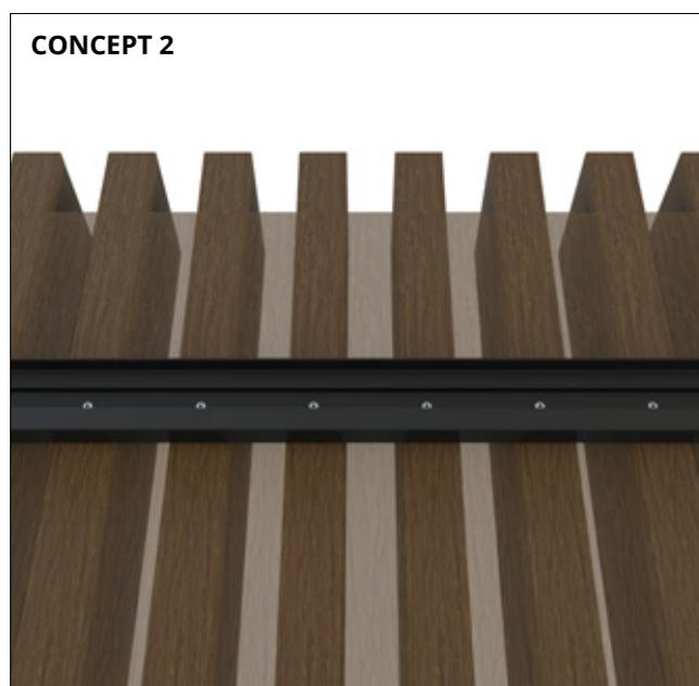
**ÉTAPE 4B** Vissage en panneaux avec le rail aluminium FD1156 préalablement découpé à la longueur souhaitée. Utilisation de la vis auto-perceuse inox A2 5.5x32mm (FD1155/FC2628).
