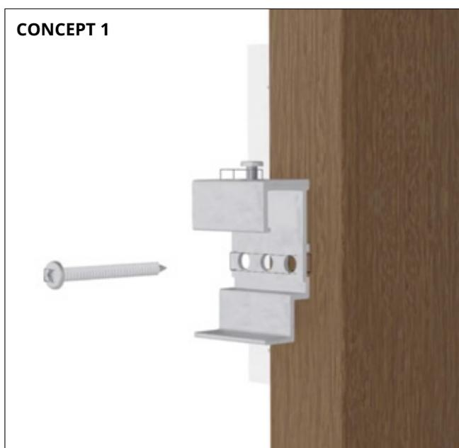
**ÉTAPE 4A** Vissage unitaire des brise-soleils à l'aide de l'agrafe FD1154. Utilisation de la vis auto-perceuse inox A2 5.5x32mm (FD1155/FC2628).
