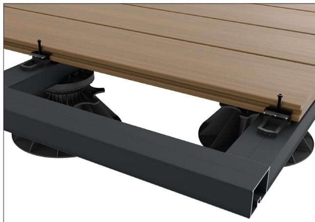
4.5 - Fixer la dernière lame avec le clip de départ / fin. Le trou oblong du clip permet de l'ajuster en fonction de la hauteur de la rainure de la lame de terrasse. Fixer la plinthe sur la périphérie du cadre à l'aide des vis inox 5,5x40 mm pour lambourde aluminium.
