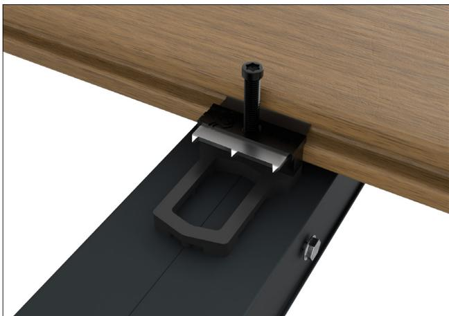
4.2 - Positionner la deuxième lame puis visser entre les 2 lames à l'aide de l'embout allongé fourni.
