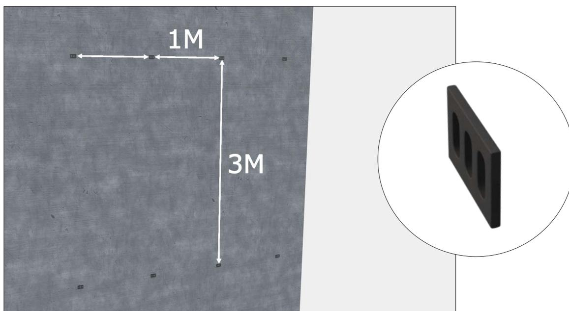
**ÉTAPE 1** Ajouter une cale rupture de point thermique (ref 1157) entre le rail et le support.
