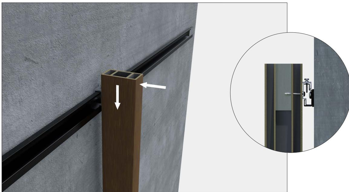
**ÉTAPE 4** Emboîter le Brise Soleil grâce à l'agrafe NV3 sur le rail.
