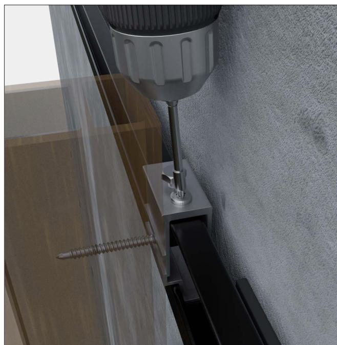
**ÉTAPE 5** Régler la verticalité du Brise Soleil avec la vis de réglage M6x20mm.
