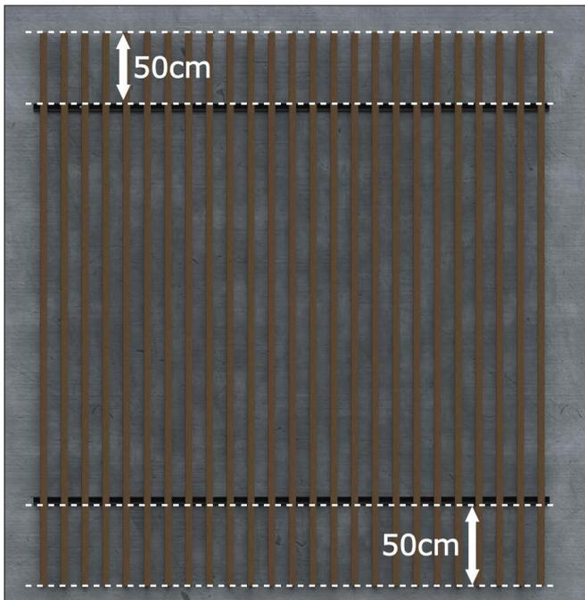
**PORTE À FAUX** Un porte à faux de 50 cm est toléré en extrémité de Brise Soleil. Le renfort aluminium doit être inséré sur toute la longueur du profil.
