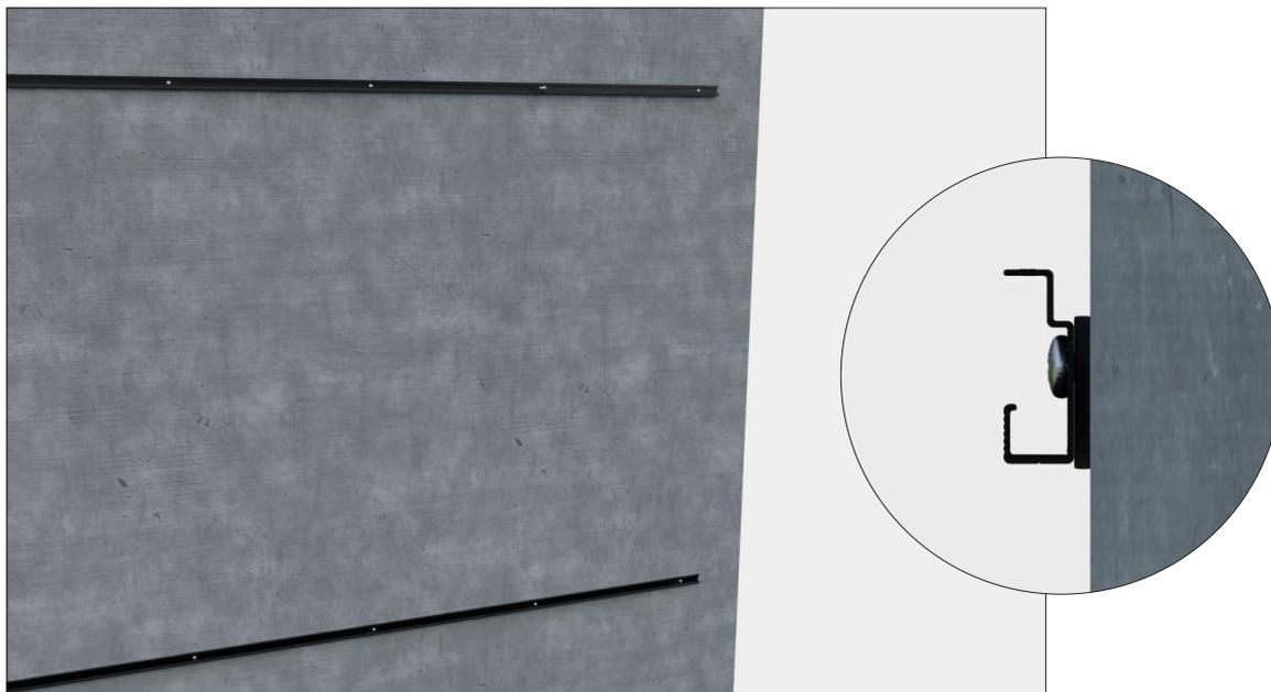
**ÉTAPE 2** Fixer le rail (ref 1156) sur le mur porteur avec des fixations adaptées au support.
