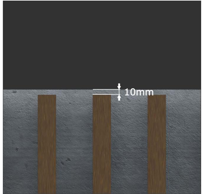
**JOINT DE DILATATION** Respecter un espace de 5mm entre 2 extrémités de Brise Soleil et 10mm entre un Brise Soleil et tous les types d'obstacles rencontrés (menuiserie, mur, angle, etc).
