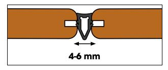
Composition: Caoutchouc élastomère thermoplastique de densité 1,18 de type TPS-S.E.B.S. Ce matériau de haute qualité possède une excellente résistance aux agents atmosphériques, au vieillissement, aux U.V. Il est 100% recyclable. Employé dans l'industrie automobile. Résiste à des écarts de températures compris entre -50°C et +90°C.
